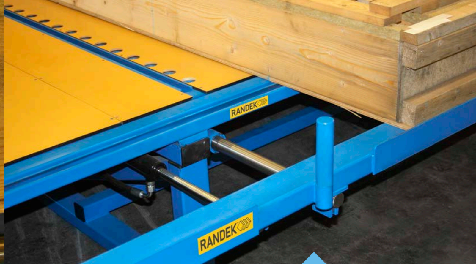
Widok pokazujący hydrauliczną regulację i docisk
